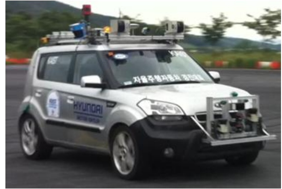
그림 1 현대 자동차에서 주직한 자율 주행 자동차 경진대회에서 사용된 각종 센서를 장착한 한국과학기술원 팀의 차량 사진
