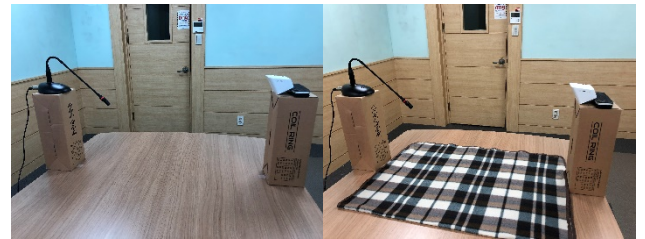
[그림 3] 소리의 이진 분류를 위한 실험 환경. 좌: 딱딱한 표면이 있는 환경. 우: 부드러운 표면이 있는 환경.
